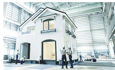
震度7連続60回の過酷な耐震実験にも耐えたモデルハウス
